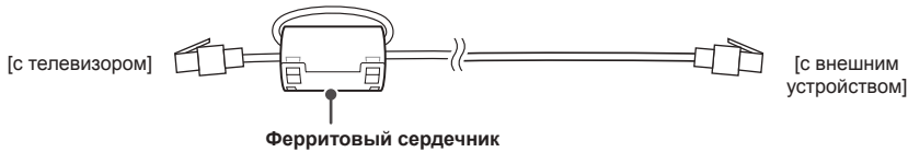
[Вид ферритового сердечника в разрезе]
